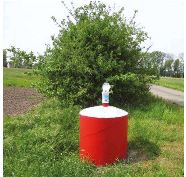
Für Grundwasser ist ein weites Netz von Grundwassermessstellen installiert, die regelmäßig Daten zum Grundwasserstand liefern. (Foto: Christiana Mühlner)
